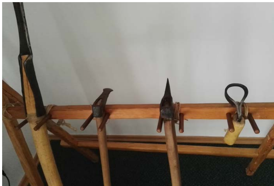
Zdj. nr. 6 Zestaw tradycyjnych narzędzi bartnych. Od lewej: piesznia, cieślca, siekiera serka, skobliczka. Autor: Sieńko A.
